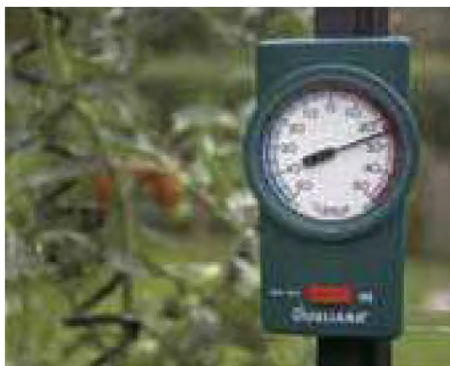
Термометр с указателем минимальной и максимальной температур – Не содержит ртути, показывает текущую температуру а также минимальные и максимальные значения температуры за прошедший период.
